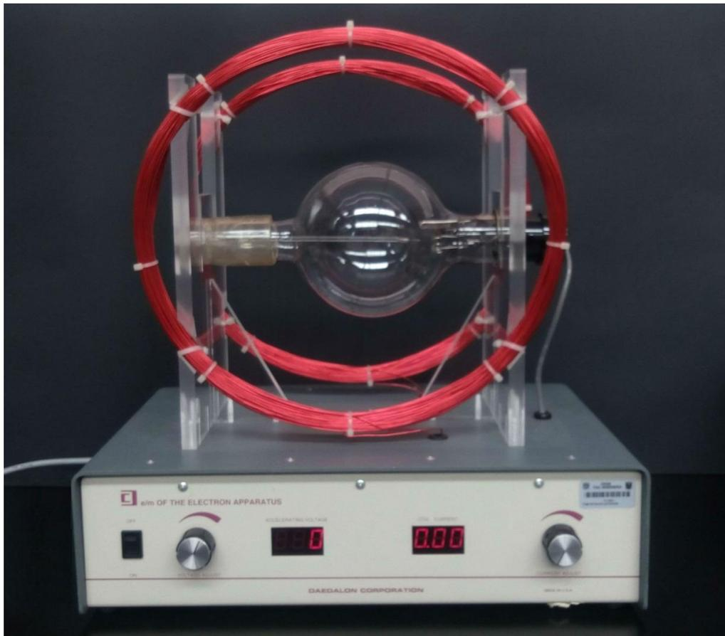
1. Compruebe que el botón de encendido esté en la posición **OFF** y posteriormente conecte el aparato a la toma de corriente.
